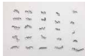
NLB Type Chipbreaker (T1500A)
