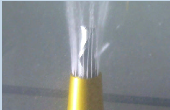
Aufsteckhülse mit Düsen – ineffektive Kühlung, Kühlmittel gelangt nicht zur Schneide Slip-on sleeve with nozzles – ineffective cooling, coolant does not reach the cutting edges
