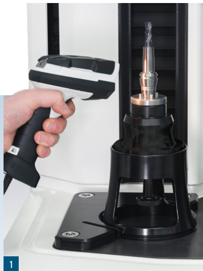
Längenvoreinstellung und Scan des Data-Matrix Codes zur automatischen Identifikation der Schrumpfparameter
