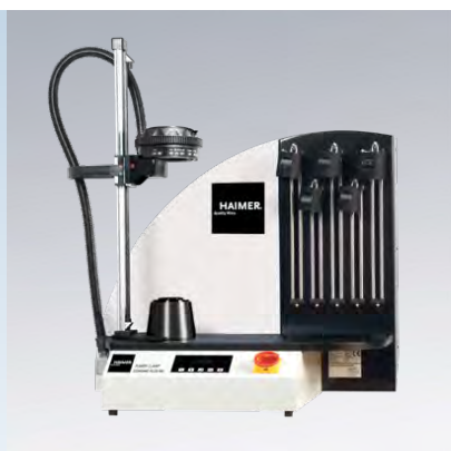
Power Clamp Economic Plus NG mit Kühlung, ohne Drehteller, inkl. 1 Aufnahmetopf und 1 Aufnahmehalter, mit Werkzeugablage
