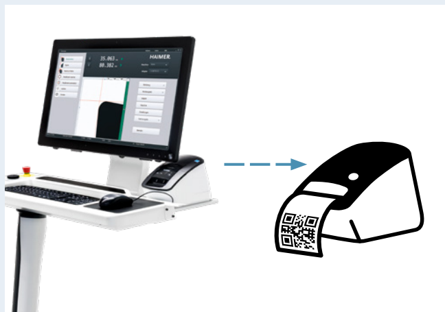
Nach dem Messen des Werkzeuges wird ein Etikett mit QR-Code gedruckt After measuring the tool, a label with the QR code is printed
