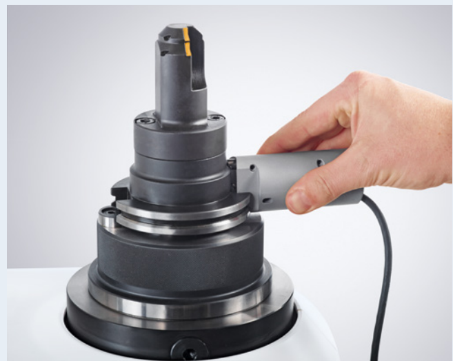
Manuelle Positionierung des Schreib-/Lesekopfes Manual positioning of the read/write head
