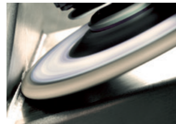
Rendabel, want volledig op te gebruiken bij de bewerking van hoeklassen
