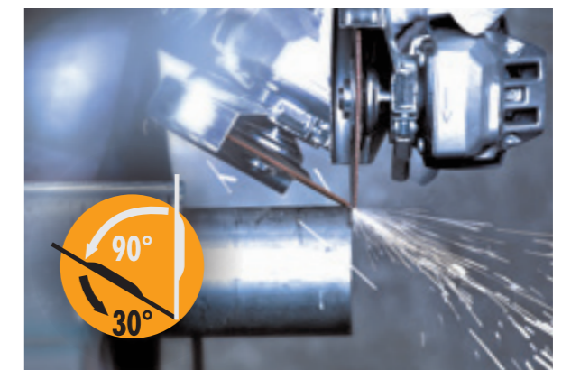
Veilig in gebruik dankzij 3 weefsellagen over het volledige oppervlak
