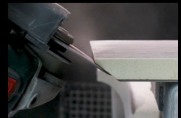
... en afkanten met één schijf zonder gereedschapswissel mogelijk.
